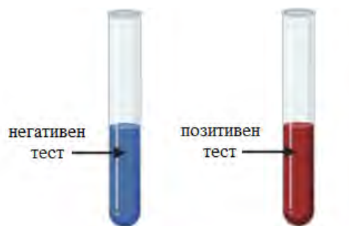
Слика 7.1. Појавата на црвенокафеав талог укажува на позитивен Фелингов тест
