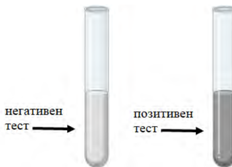
Слика 7.2. Појавата на сив талог или сребрено огледало укажува на позитивен Толенов тест
